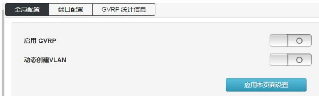
将开启的 GVRP 功能应用到制定端口上，并配置其定时器：
